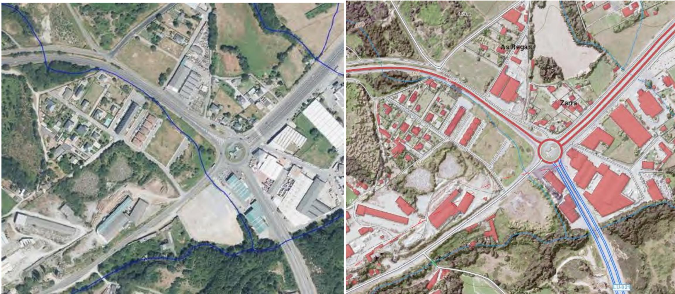
Cartografía de fondo empleada en el visor del plan básico autonómico. Figura un cauce secundario que discurre por la cuneta de la Ronda Norte. Se trata de una representación no ajustada a la realidad actual en el tramo paralelo a la Ronda Norte, puesto que la escorrentía discurre por la cuneta de la Ronda Norte en todo su trazado hasta Adolfo Suárez
