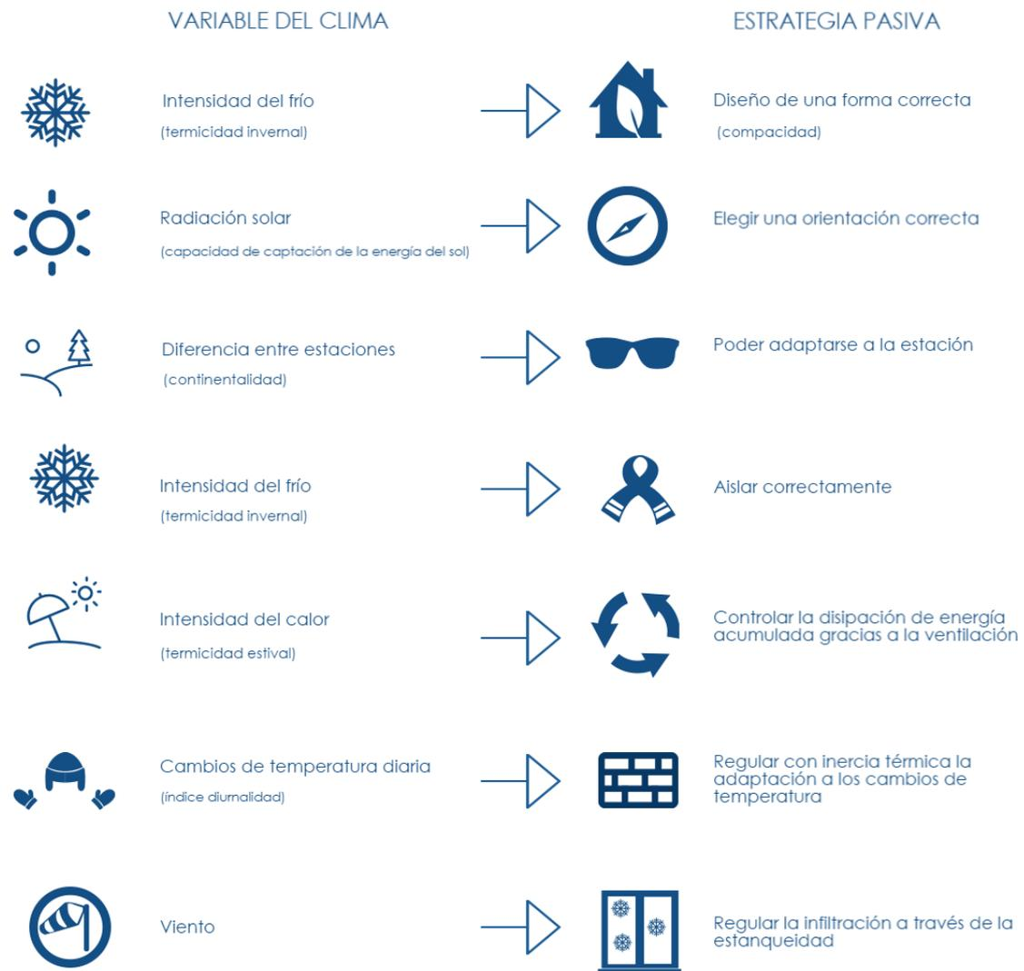
*Ilustración: Esquema global en el que se relaciona característica del medio con solución constructiva.*
