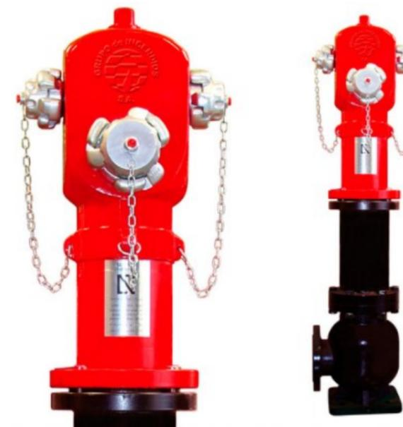
Hidrante con forma de columna, cuya columna se vacía automáticamente cuando se cierra la válvula principal para protegerlo contra heladas, diseñado para suministrar gran cantidad de agua en poco tiempo. Permitiendo la conexión de mangueras y equipos de lucha contra incendios, además del llenado de las cisternas de los camiones de bomberos.
