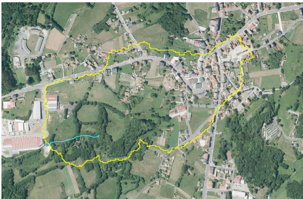
Ilustración 5: Cunca de recepción da canle de estudo
