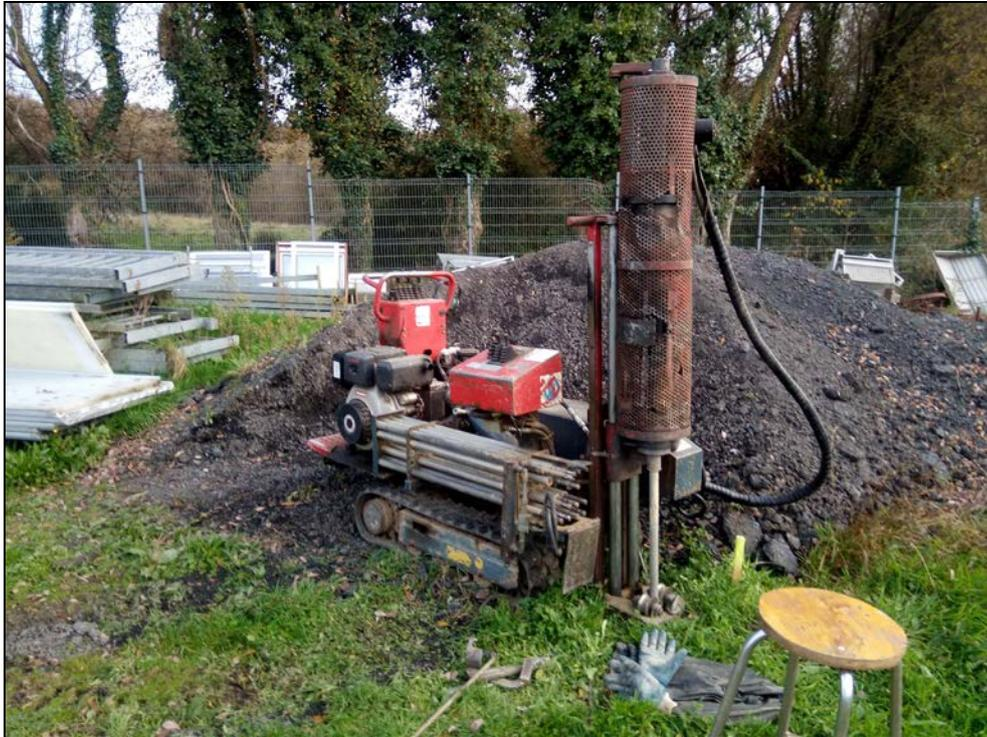
Fotografía 24: Ensayo de penetración PD-4.
