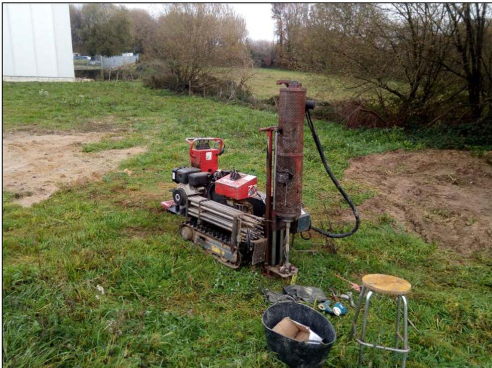
Fotografía 21: Ensayo de penetración PD-1.
