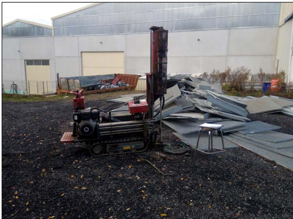
Fotografía 23: Ensayo de penetración PD-3.
