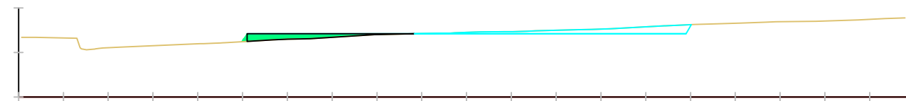
Pk=0+032 S. TERRAPLÉN = 7.25 m2. S. DESMONTE = 12.68 m2.
