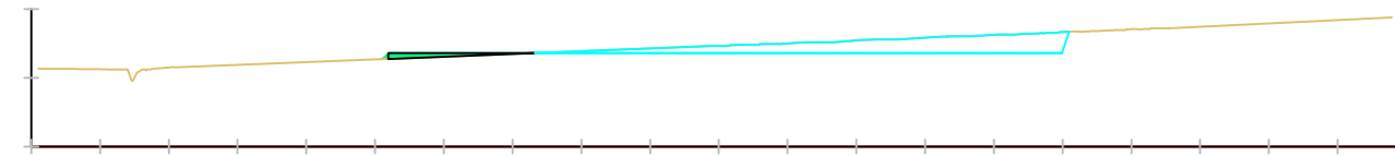
Pk=0+058 S. TERRAPLÉN = 2.28 m2. S. DESMONTE = 28.80 m2.
