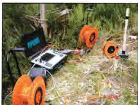
Figura 3.- Fotografía de campo de los sensores utilizados para mediciones de refacción
