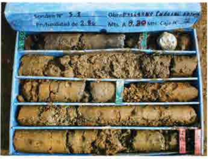
Fotografía 2 Sonda S-1 Caja 2 De 2.80 a 8.30 m.
