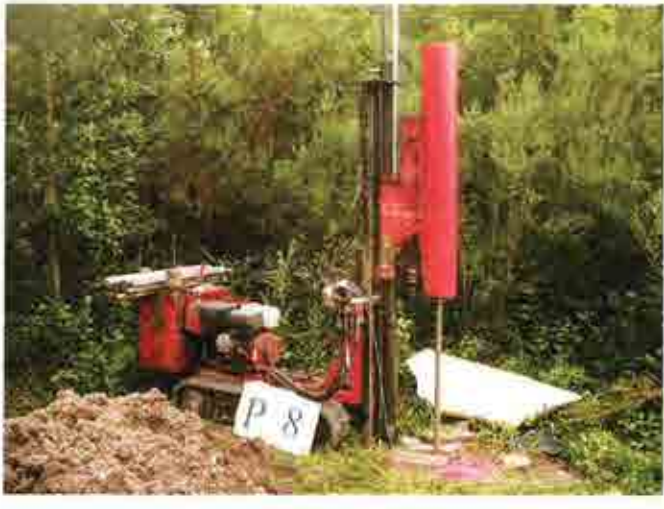
Fotografía 4 Situación del ensayo de penetración dinámica superpesada P-8
