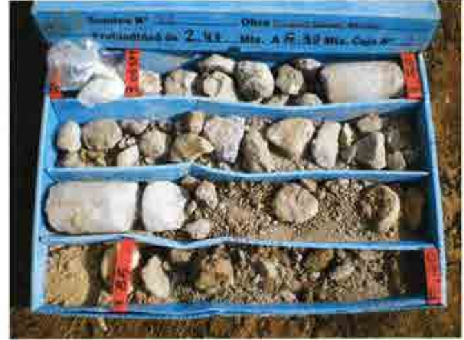
Fotografía 3. Sonda S-2. Caja 2. De 2.40 a 5.30 m
