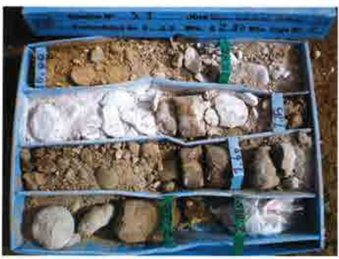
Fotografía 1 Sonda S-1 Caja 1 De 0.00 a 2.80 m.
