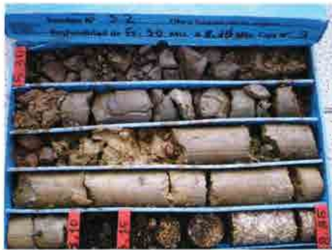
Fotografía 4. Sonda S-2 Caja 3 De 5.30 a 8.35 m
