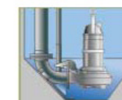
El diseño del pozo TOP con conexión de descarga integrada. Sus lados achafanados provocan una velocidad elevada del caudal, creando una turbulencia que re-suspende los sólidos, aumentando radicalmente el transporte de sólidos.
